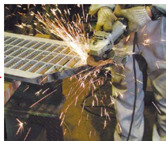
ディスクサンダーで溶接箇所を整える
