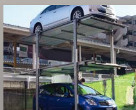
機械式立体駐車設備
