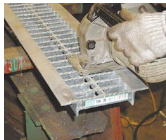
グレーチングをカット
