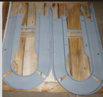
ชิ้นส่วนที่อ่อนแอซึ่งเปลี่ยนรูปได้ง่ายภายใต้อุณหภูมิสูง
